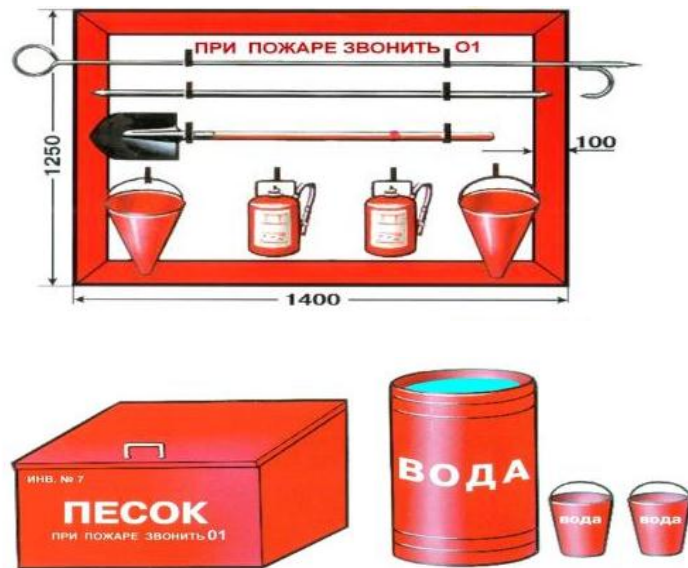
Рисунок 6 - Пожарный щит первичных средств пожаротушения
