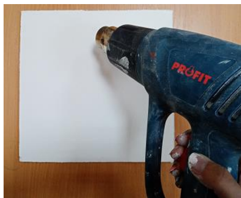
Рисунок 16- Ускоренная просушка слоя грунта феном.
