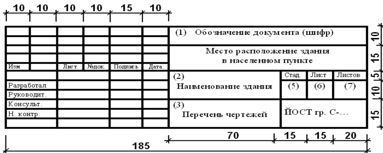
Рисунок 8 - Основная надпись на чертежах АС
