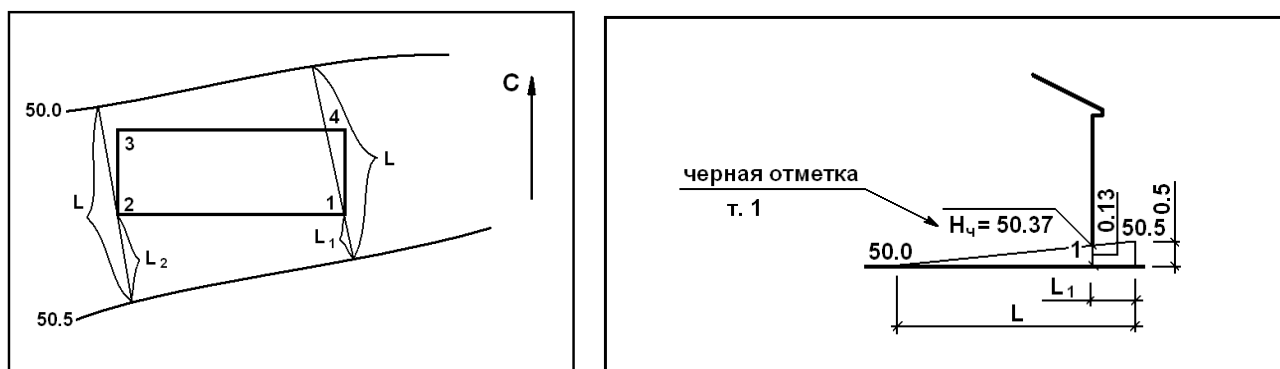
Рисунок 42 - Пример определения черных отметок здания
