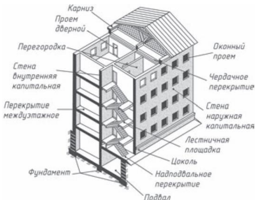
Рисунок 42 – Основные элементы здания.
