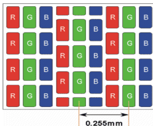
Рис. 32. Шелевая или гнездовая маска ЭЛТ
