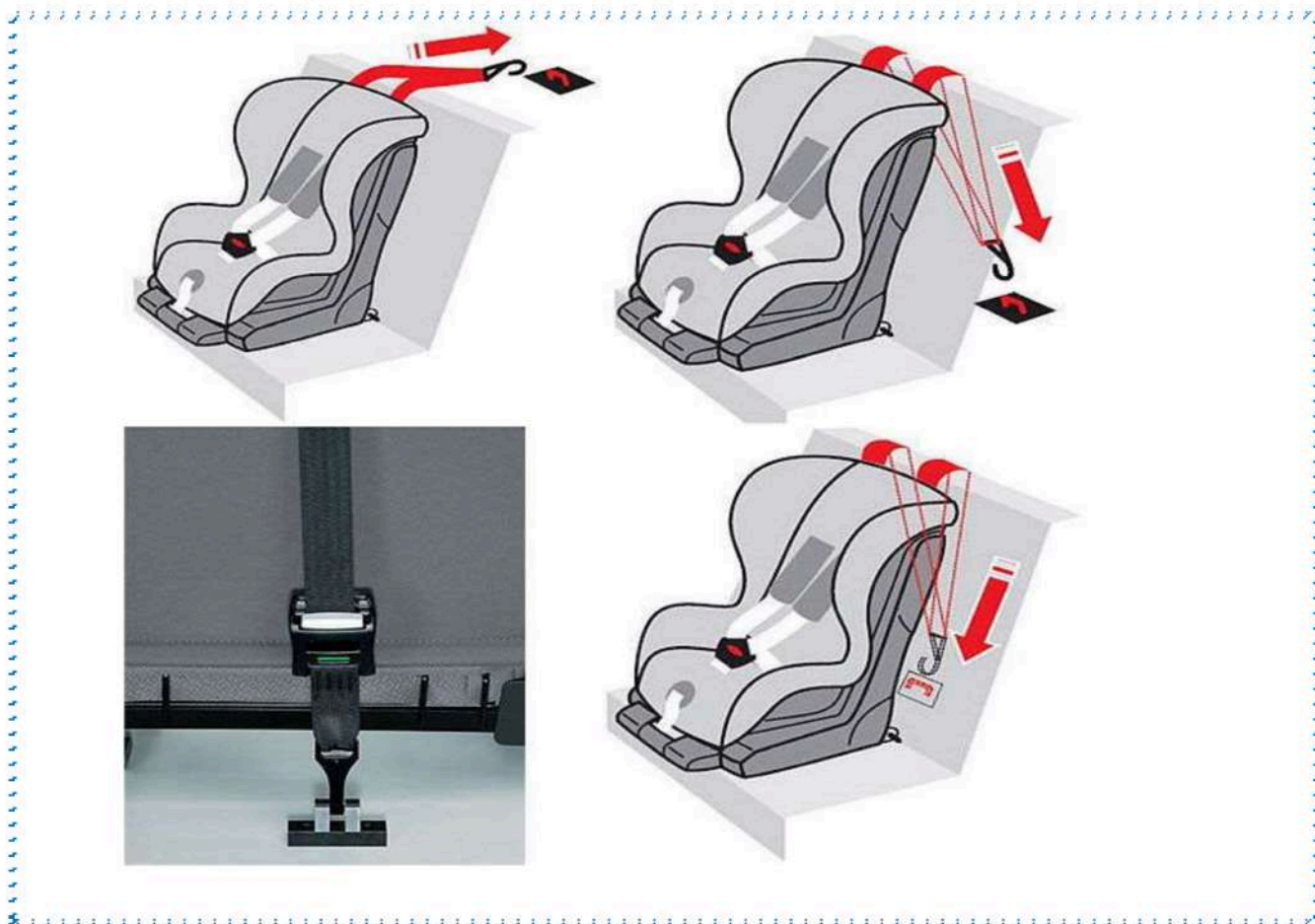
Рисунок 7. Способы фиксации якорного крепления
