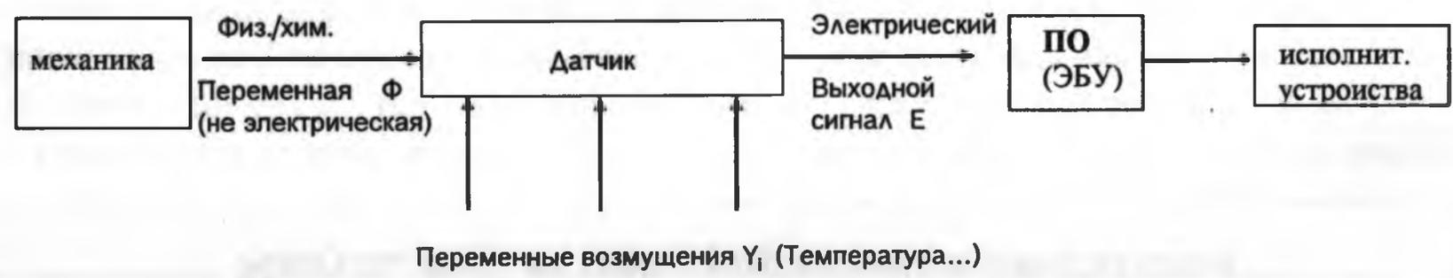
Датчики и исполнительные устройства, как периферия, формируют интерфейс между транспортным средством и его сложными функциями, включающими привод, тормоза, подвеску и шасси и т.д. как блоки обработки.
