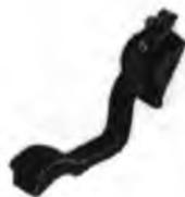
Угловые датчики : Датчик педали акселератора, датчик угла поворота рулевого колеса,
