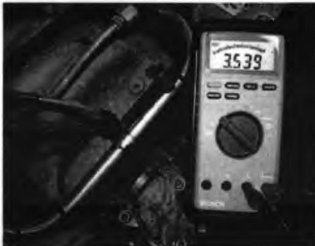
Измерение напряжения: Разъём установлен, зажигание ВКЛ.
