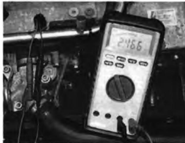
Измерение сопротивления: Разъём снят, зажигание ВЫКЛ.
