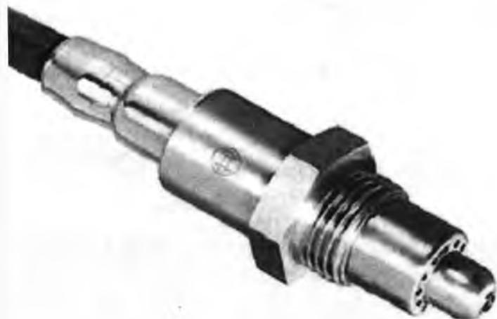
Лямбда-датчик LSF Xfour представляет собой планарный 2-точечный датчик  $\lambda = 1$ , выполненный из  $ZrO_2$  (принцип Nernst) с насосным опорным током и встроенным нагревателем. Он подходит не только для установки в качестве 2-точечного датчика управления в  $\lambda = 1$  легковых автомобилях - четырехтактных бензиновых двигателях, а также в качестве датчика контроля каталитического нейтрализатора в системах OBD (бортовой диагностики).
