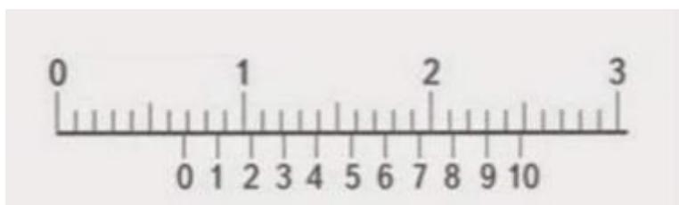
1. Показания шкалы штанги и нониуса при измерении размеров – 6,4 мм.
