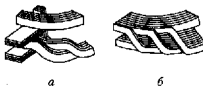
Рис. 1.12. Транспозиция в винтовых обмотках
