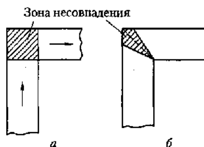
Рис. 1.7. «Зоны несовпадения» при прямом (а) и косом (б) стыках
