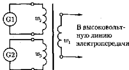
Рис. 3.2. Трехобмоточный трансформатор с двумя первичными обмотками
