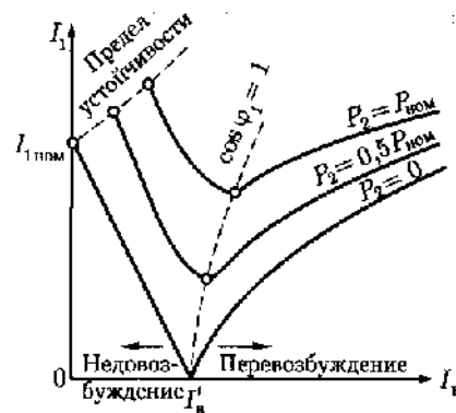
Рис. 21.11. U-образные характеристики синхронного генератора
