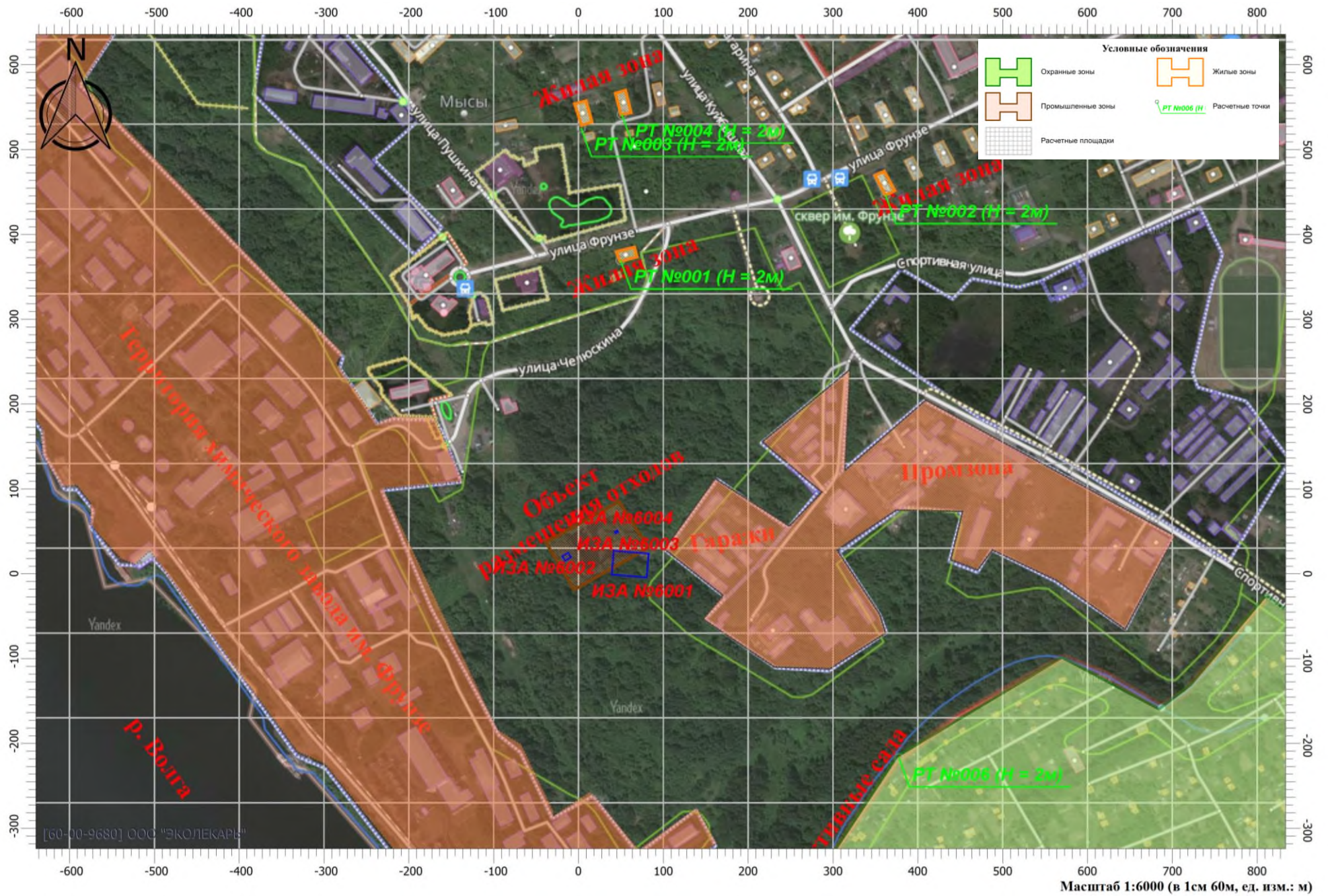
Рис. 3.1. Карта-схема объекта размещения отходов с указанием источников выбросов и расчётных точек.
