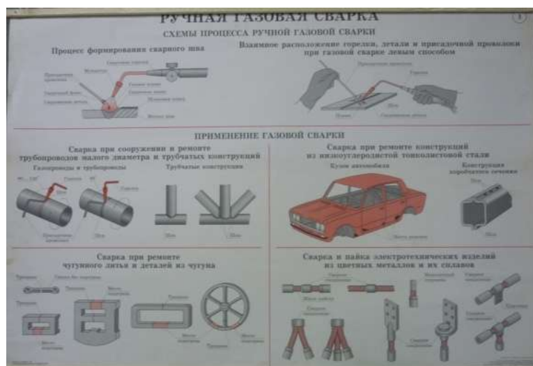
Ручная газовая сварка
