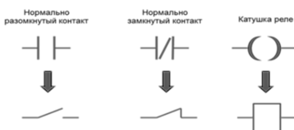
Рисунок 4.6 – Синтаксис языка для замены логических схем, выполненных на релейной технике
