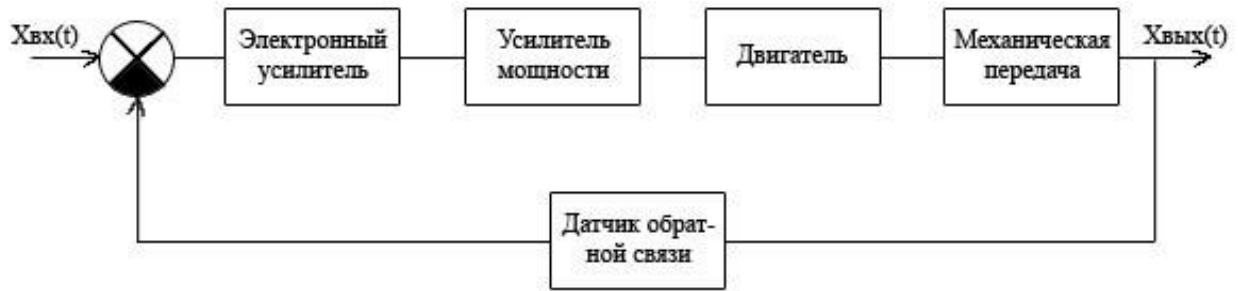
Рисунок 3.11 – Функциональная схема привода главного движения станка
