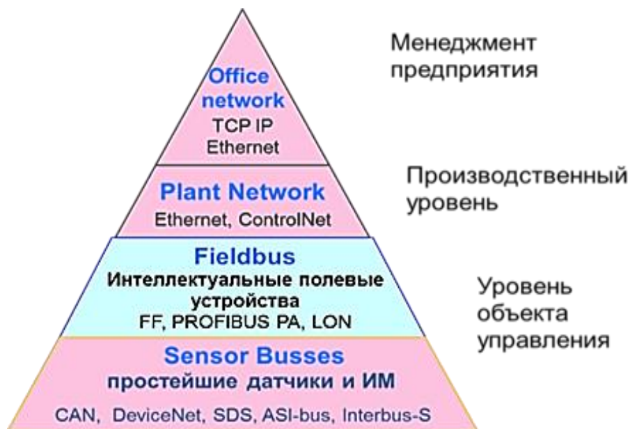
Рисунок 2.61 – Иерархическая структура промышленной информационной сети
