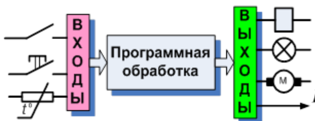
Рисунок 2.58 – Принцип работы ПЛК
