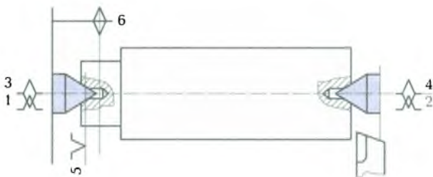
Рис. 2.6. Реализация двойной направляющей базы сочетанием двух поверхностей
