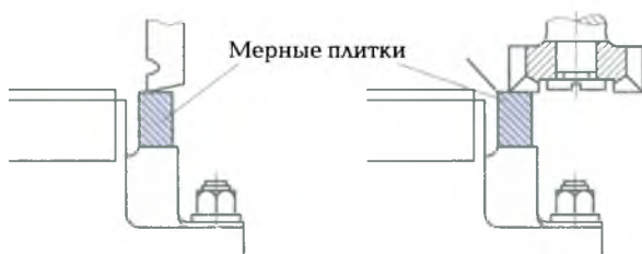
Рис. 4.18. Использование плоскопараллельных концевых мер (плиток) для статической настройки размерных цепей технологической системы
