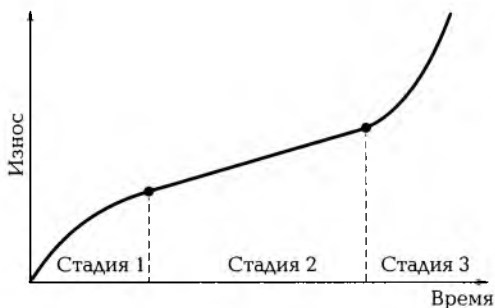
Рис. 3.1. Характер процесса износа деталей при эксплуатации машины
