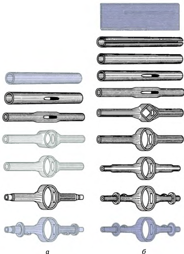
Рис. 7.1. Два различных способа получения заготовки корпуса заднего моста грузового автомобиля:
