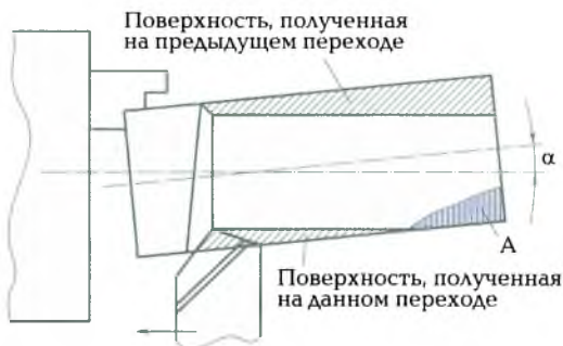
Рис. 6.4. Сохранение части поверхности, полученной на предыдущем переходе, из-за погрешности установки детали на данном переходе
