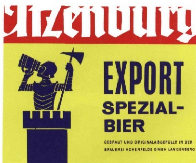
170. Оттиск, полученный при измененном порядке наложения красок на четырехкрасочной машине: пурпурная — желтая — свободная секция — голубая с добавкой кроющих белил
