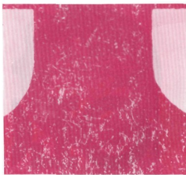
108. Лицевая сторона оттиска с выщипанными частицами волокон (в увеличенном виде), которые налипают на обратную сторону оттиска
