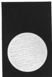
266. Фрагмент забракованного оттиска из-за неудовлетворительной прочности краски на истирание
