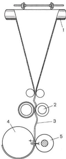
251. Неплотный контакт натяжных валиков: 1 — бумаговедущий валик фальцворонки; 2 — натяжные ролики; 3 — участок слабого натяжения полотна; 4 — цилиндр с графейками; 5 — цилиндр с фальцножом
