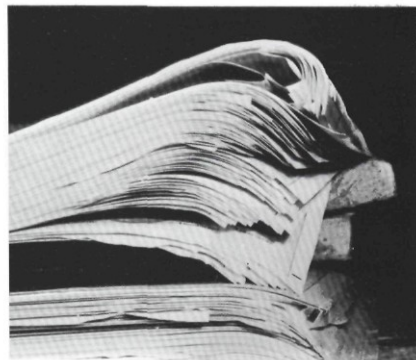
123. Оттиски, опечатанные краской высокой вязкости: сильное скручивание хвостового края при выводе оттиска на приемный стол свидетельствует о повышенной липкости краски
