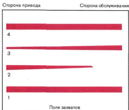
98. Следы, оставленные четырьмя накатными красочными валиками после их опускания на лист бумаги, обтягивающий офсетный цилиндр: 1, 2, 3, 4 — следы от первого, второго, третьего и четвертого накатных красочных валиков
