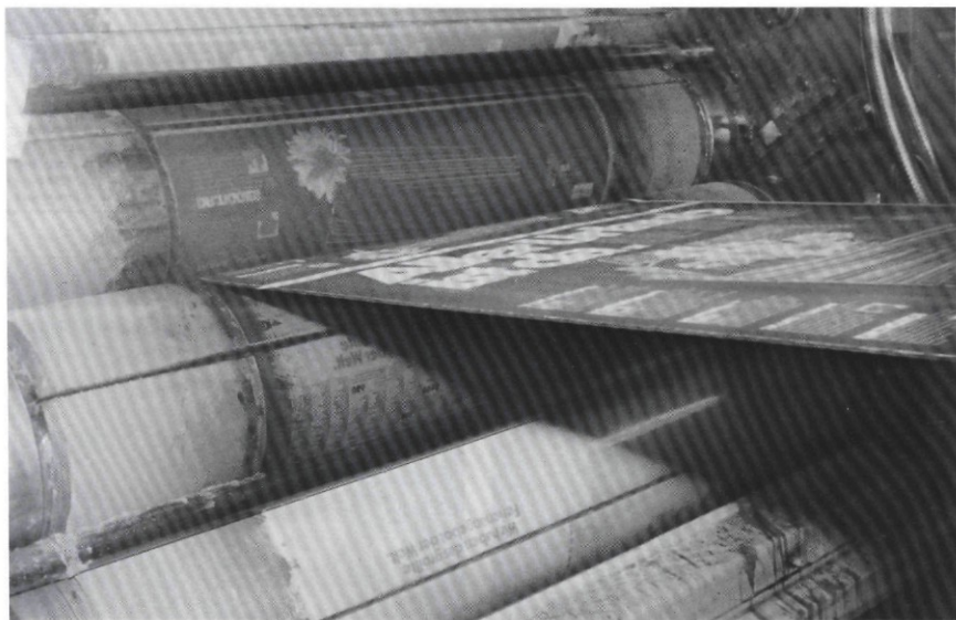
280. Налипание краски на края бумажного полотна при его ширине 60 см и ширине печатной секции 96,5 см
