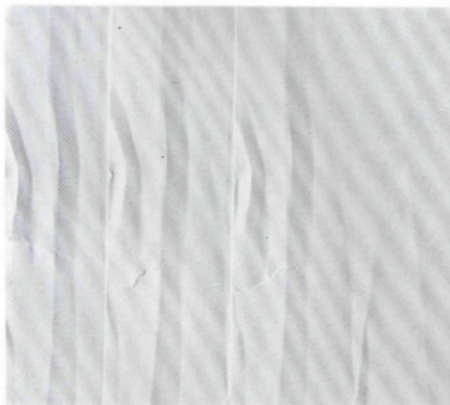
257.1. Поврежденное бумажное полотно и его кромка
