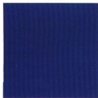
175. Некачественный оттиск при печатании «по-сырому»
