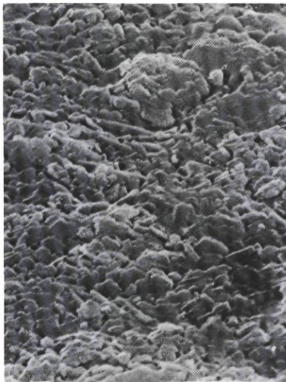
265. Микрофотографии поверхности матовой мелованной бумаги при увеличении в 5000 раз. Отчетливо видна более шероховатая поверхность по сравнению с бумагой машинного мелования
