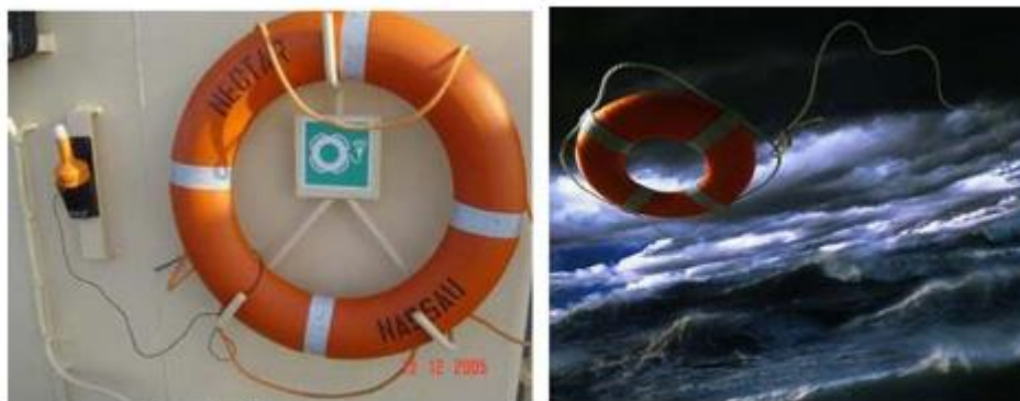
Спасательный круг с самозажигающимся огнем
