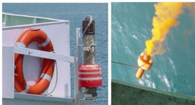
Круг с самозажигающимися огнем и дымовой шашкой
