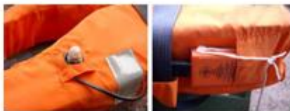
Сигнальная лампочка и батарея спасательного жилета
