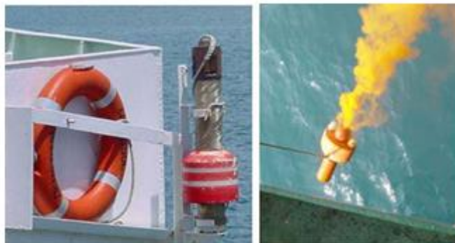
Круг с самозажигающимися огнем и дымовой пашкой
