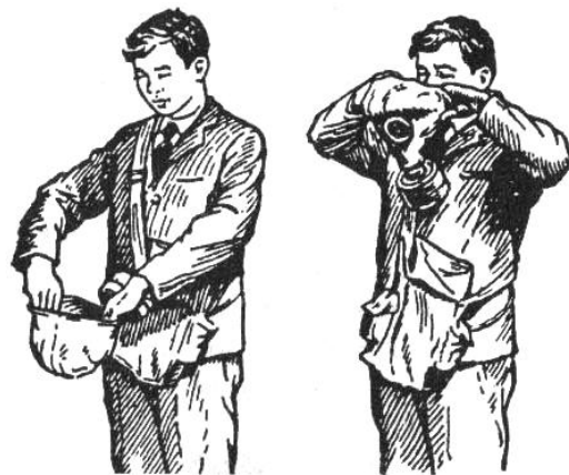
Рис.3 Надевание противогаза ГП-5
