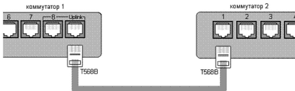
Использование порта “Uplink” для подключения кабеля с разводкой по стандарту T568B – T568B
