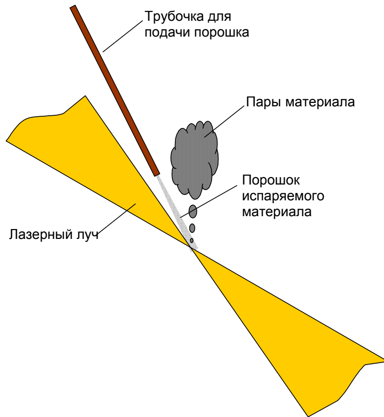
Figure 9. Испарения керамического порошка в лазерном луче. Схема процесса.
