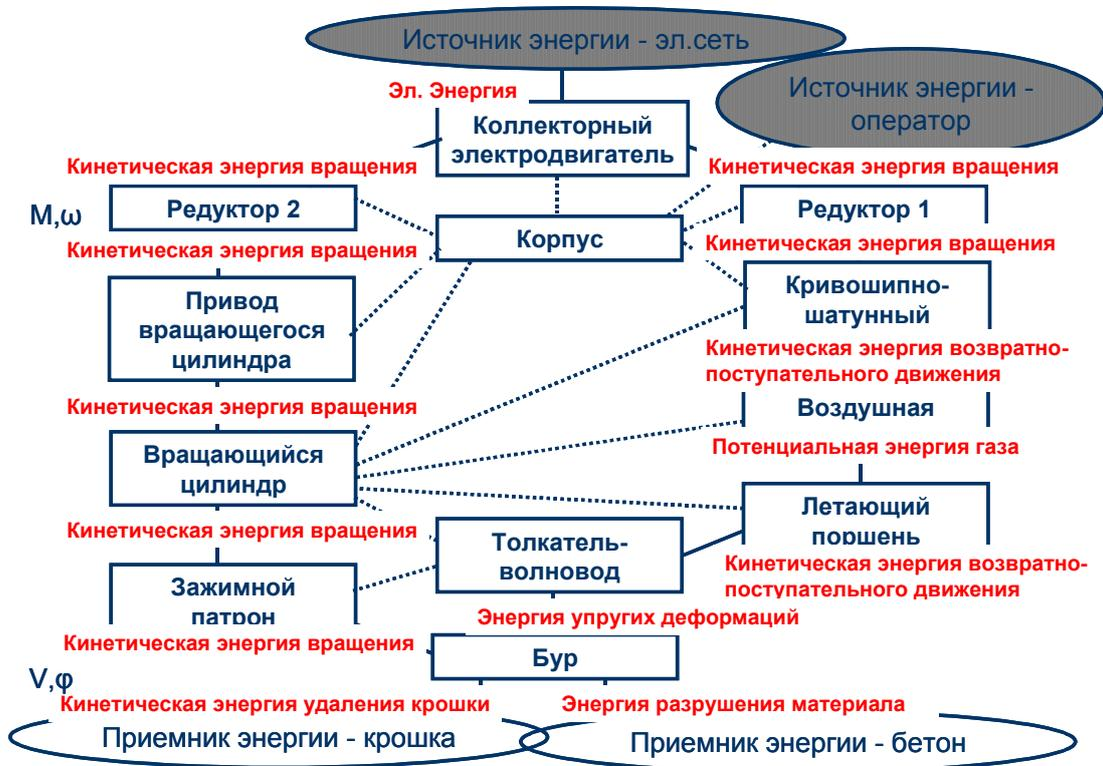
Рис.П.3-8-3. Структурная модель перфоратора с нанесенными потребителями энергии
