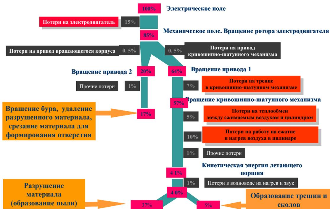
Рис.П.3-8-5. Поточковая модель электроэнергии с нанесенными численными значениями параметра - электрический ток
