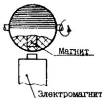
верстии, образуя контакты. Шарик при перемещении, попадая в отверстие, замыкает соответствующий контакт.
