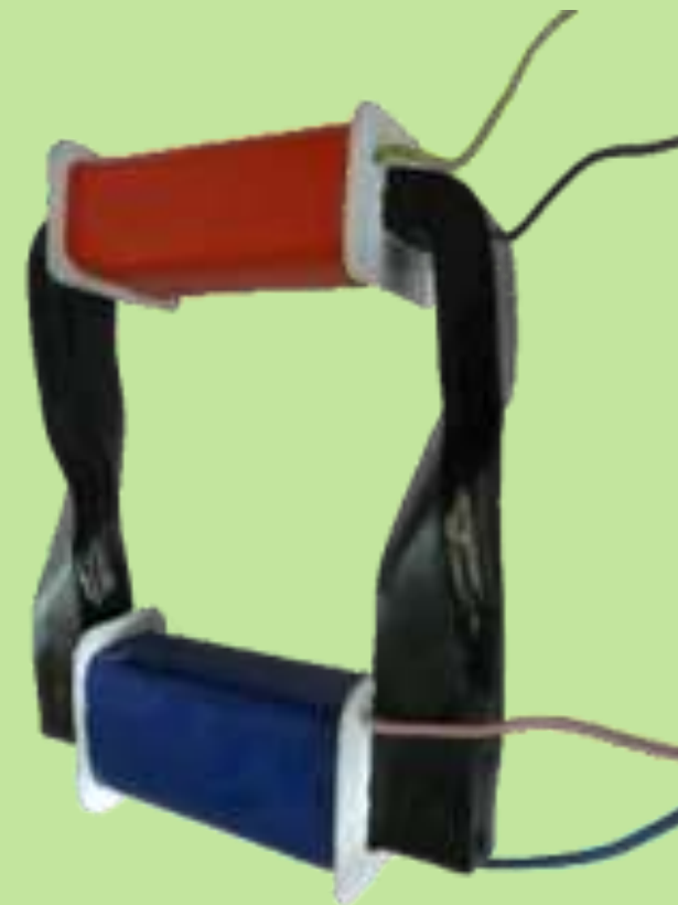
Стержневой двухкатушечный магнитопровод с топологией лист Мебиуса
