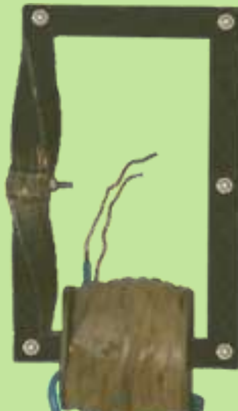
Стержневой магнитопровод с топологией лист Мебиуса
