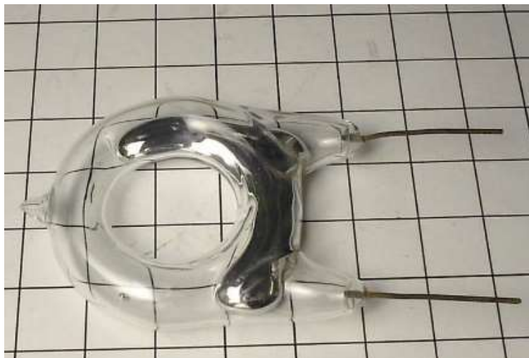
Рис. 5. Ртутный прерыватель тока. Пустота вытесняет ртуть между контактами при определенном положении прерывателя и ток прекращается. Пустота является элементом.
