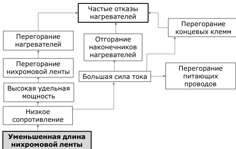
Рисунок 7 – причинно-следственный анализ низкого показателя надежности нагревательных элементов.
