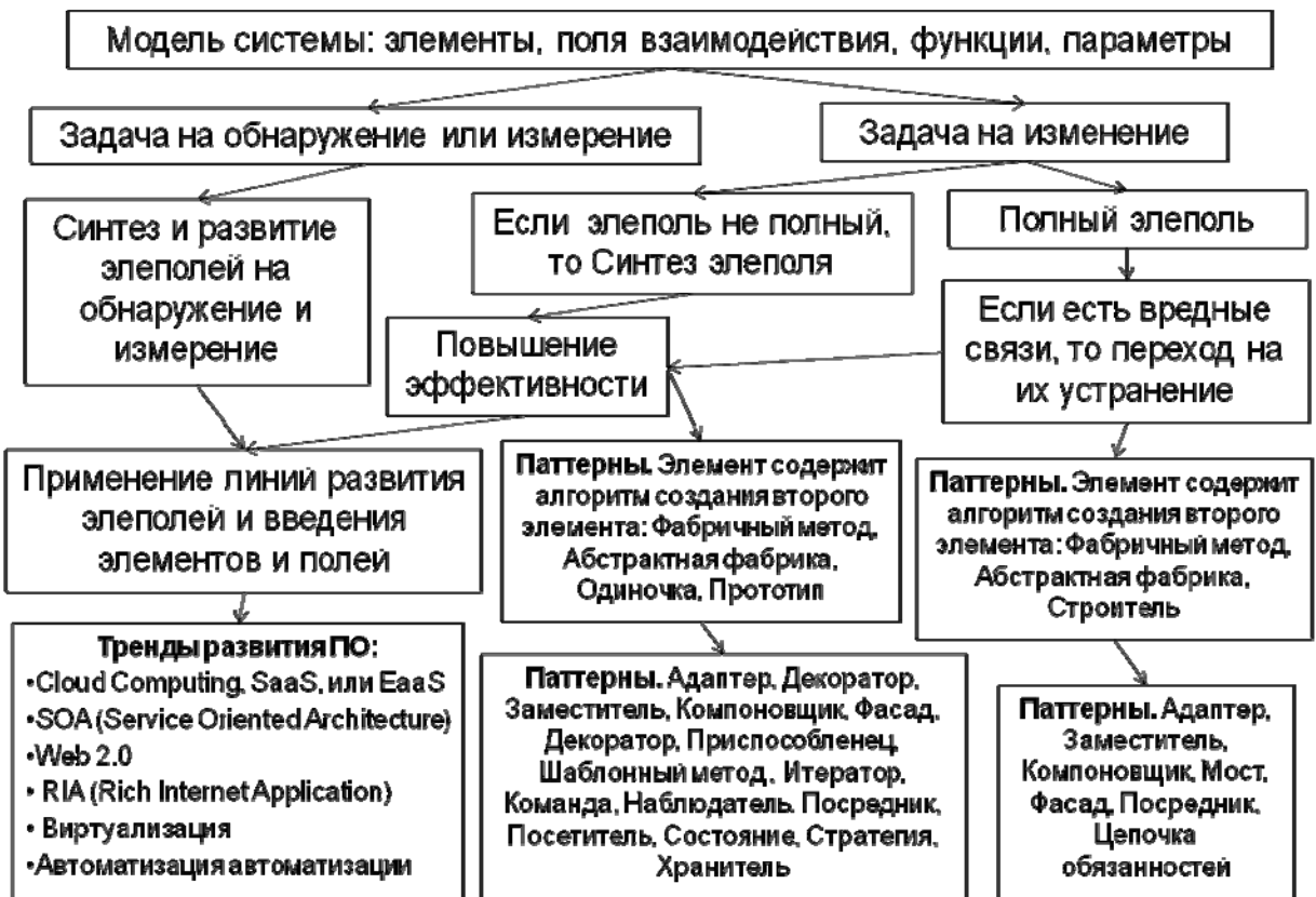
Рисунок 5. Структура алгоритма использования стандартов и паттернов АИСТ-2010-П
