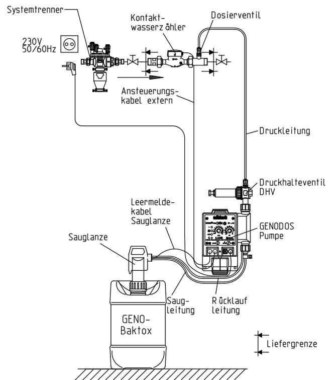
Abb. 3: Dosieranlagen GENODOS® DM-B 10 – DM-B 30
