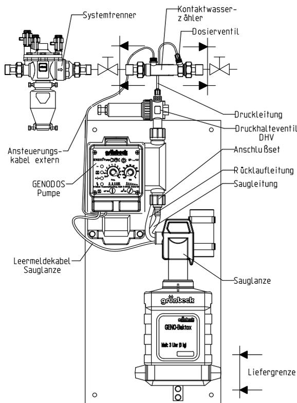
Abb. 2: Dosieranlage GENODOS® DM-B 6
